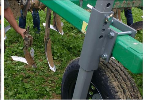
Ein gut für die tiefere Lockerung geeignetes Gerät ist der Delta-Lockerer von Hatzenbichler.
